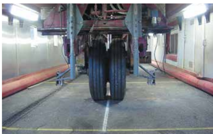
Для оценки эффекта стабилизации от применения георешетки Тенсар в жестких дорожных одеждах компания Тенсар регулярно проводит как лабораторные тесты, так полномасштабные испытания.
